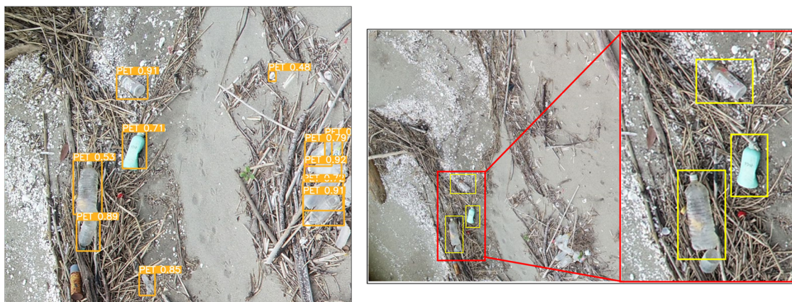
図-2 UAV で空撮した画像を元に画像認識アルゴリズムで検出した結果
